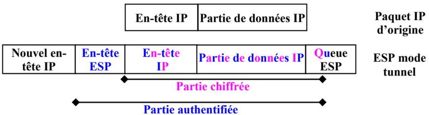
**Figure 6.11.** Encapsulation ESP en mode tunnel
