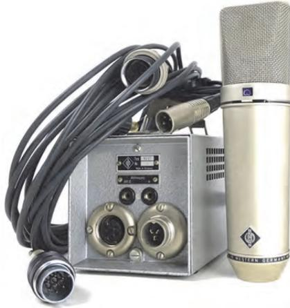
**Figure I.3.** *Le fameux microphone à tube Neumann U67 et son alimentation*
